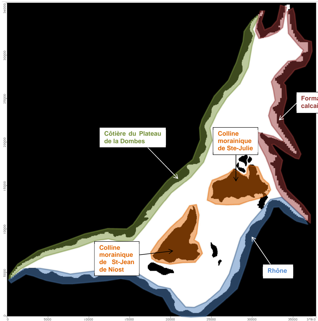
Figure N° 10. LOCALISATION DES DIFFERENTES LIMITES HYDROGEOLOGIQUES DU MODELE.
