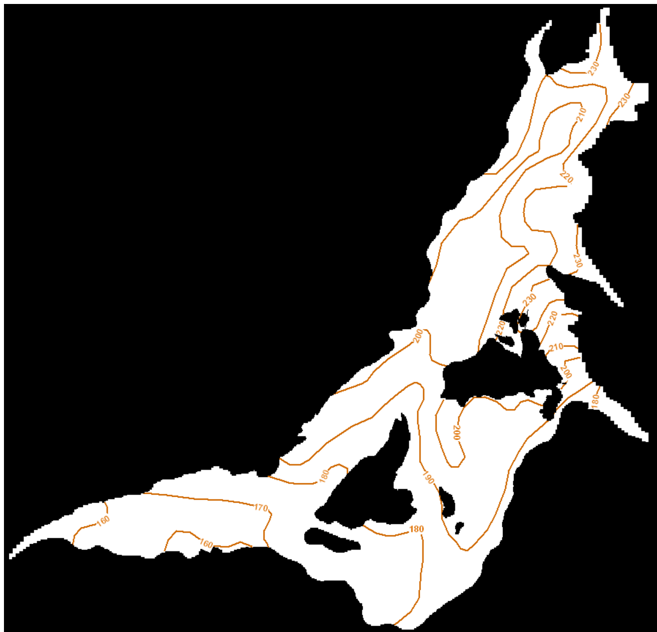
Figure N° 8. ESQUISSE CARTOGRAPHIQUE DU SUBSTRATUM IMPERMEABLE INTEGRE DANS LE MODELE HYDRODYNAMIQUE.
