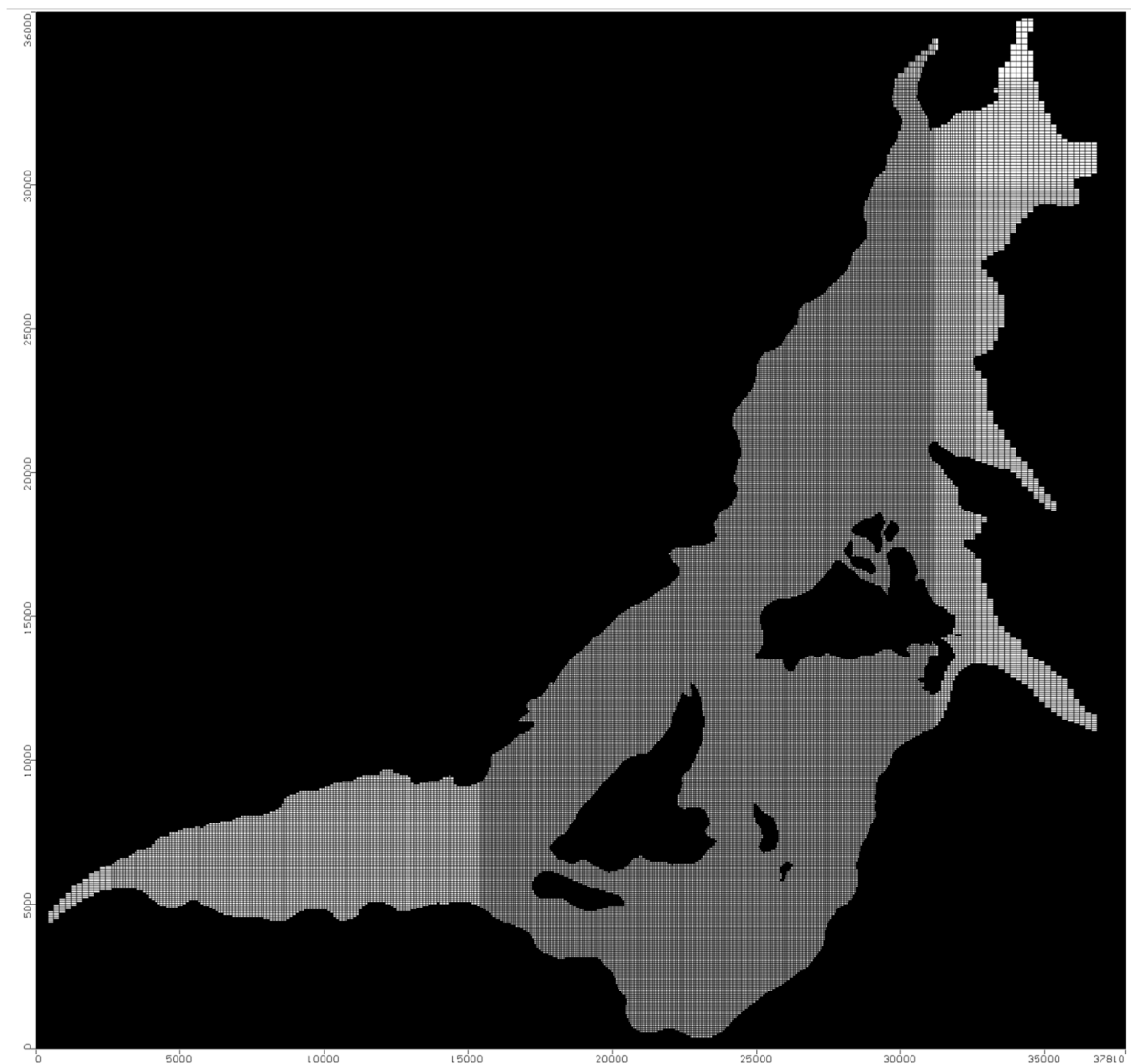
Figure N° 5. MAILLAGE DU MODELE
